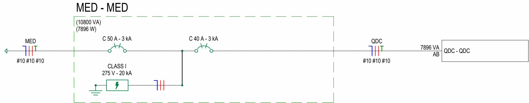
Diagrama Unifilar MED
